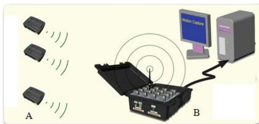
Figura 9: Eletromiografia de superfície, mostrando eletrodos (A), sensor wireless (B) e computador para armazenagem dos dados (modificado de Delsys, 2012).
